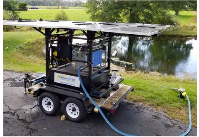
Şekil 25: Max Pure güneş enerjili mobil su arıtma cihazı [116] .
