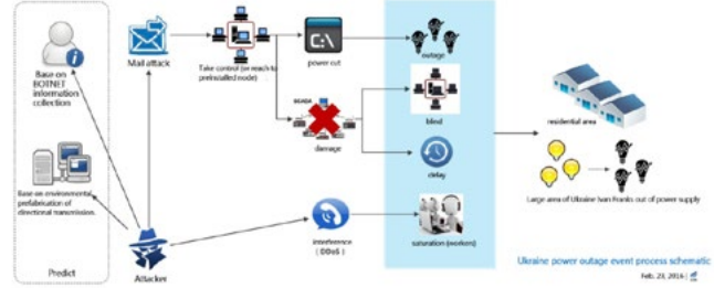
Şekil 23: Ukrayna Elektrik Kesintisi Saldırısının Genel Şeması.
