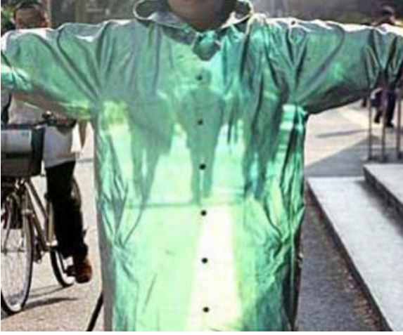
Şekil 3: Bilkent Üniversitesi NANOTAM araştırmacılarının geliştirdiği, cisimleri belli frekanslarda görünmez kılan nanoteknoloji tabanlı malzeme 17 .
