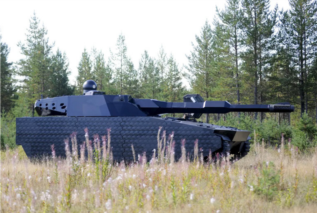
Şekil 1: BAE Systems'in geliştirdiği ADAPTIV adlı kamuflaj sistemi 11 .
