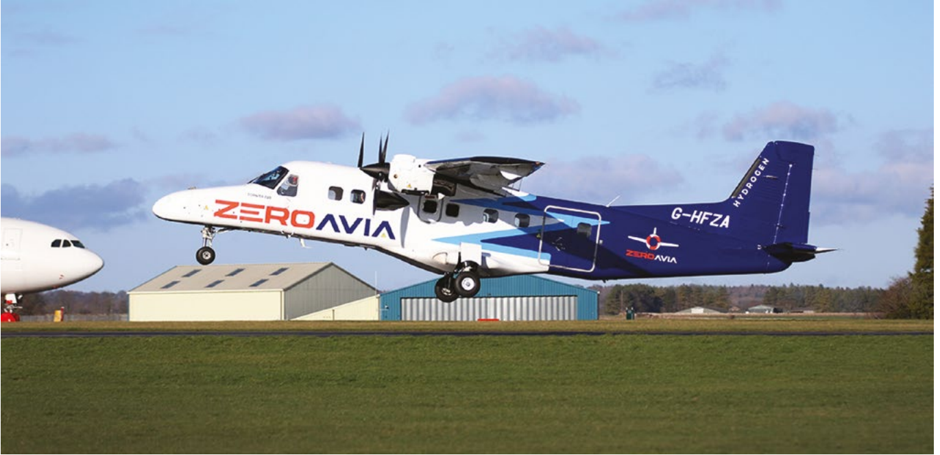
Şekil 2: ZeroAvia'nın iki hidrojen yakıt hücresinden kısmen güç alan 2 MW'lık bir elektrik motoruna sahip olan bir prototip pervaneli uçağı [23] .
