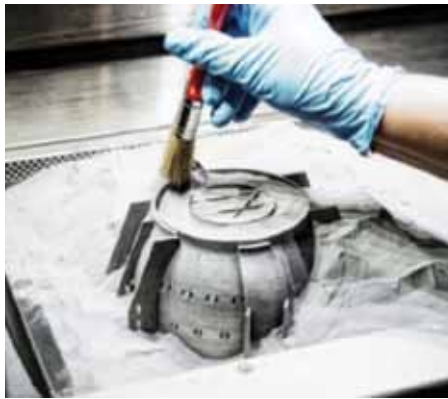
Şekil 10: TEI'de Kurulu Metal Katmanlı İmalat Tezgâhı ve Üretimi Üzerine Çalışılan Yanma Odası
