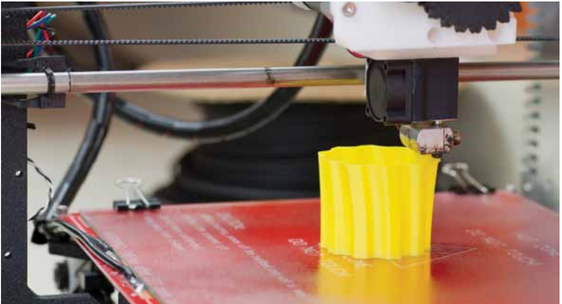
Şekil 4: Erimiş Malzeme Şekillendirme (3 Boyutlu Yazıcı)
