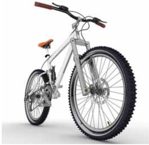
Şekil 6: Titanyum Alaşım ile İmal Edilmiş Bir Bisiklet Gövdesi
