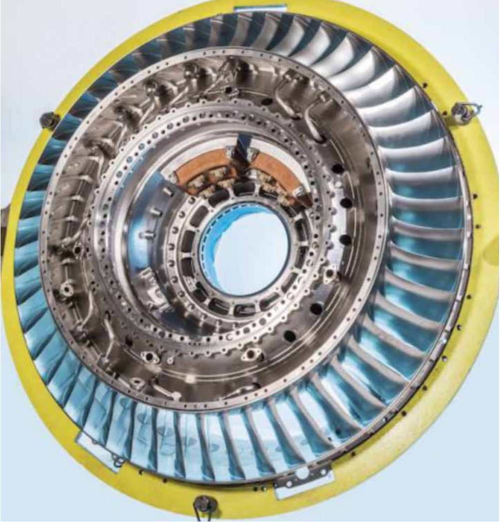
Şekil 14: Rolls Royce Trent XWB Motoru “Front Bearing Housing” Parçası
