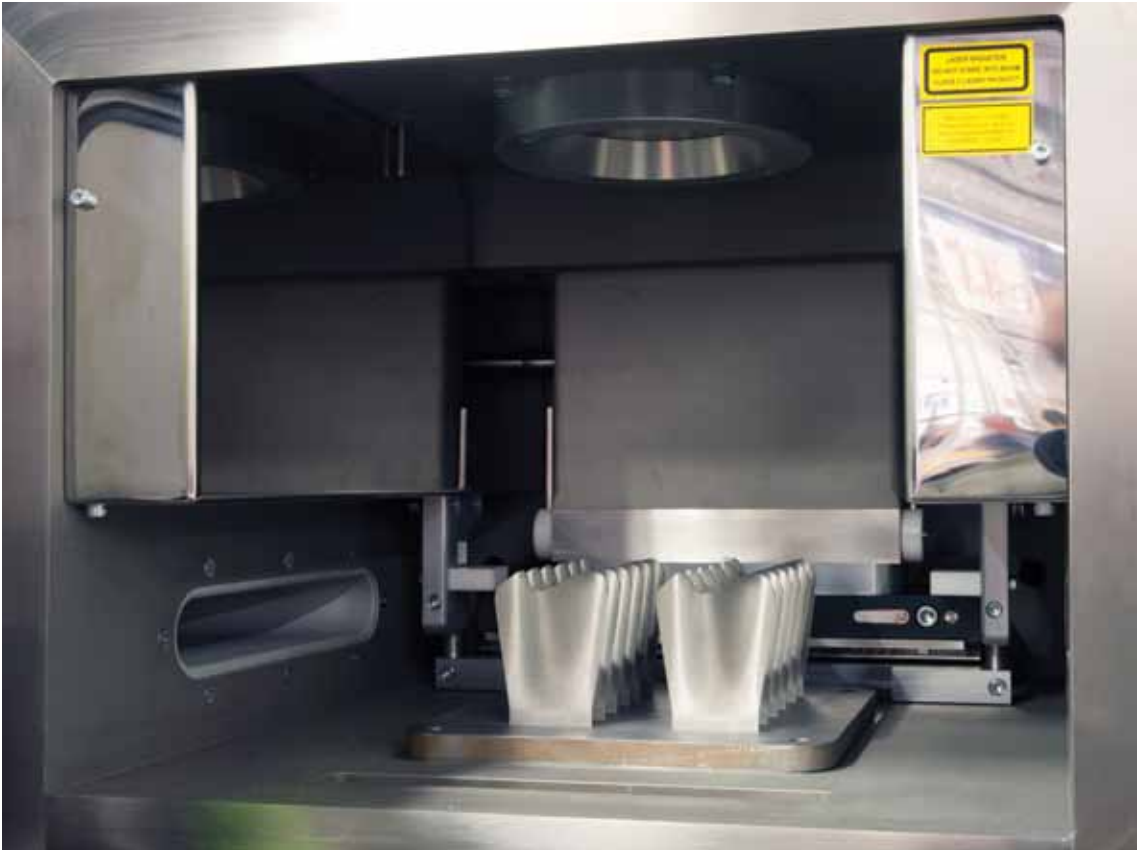
Şekil 3: Toz Yataklı Lazer Eritme Sistemleri
