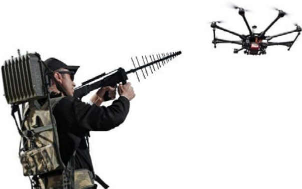
Şekil 21: Silaha benzeyen bir anten, gözetleme sistemi ve içinde bataryalar bulunan bir sırt çantasından oluşan İhasavar Anti-Drone Sistemi ( http://www.millisavunma.com/drone-savar-sistemleri/ )
