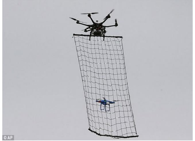
Şekil 10: Ağ taşıyan bir drone başka bir drone'u etkisiz hale getirirken ( https://www.dailymail.co.uk/sciencetech/article-3356746/How-catch-drone-BIGGER-drone-giant-net-Tokyo-police-reveal-bizarre-U-AV-catcher.html )
