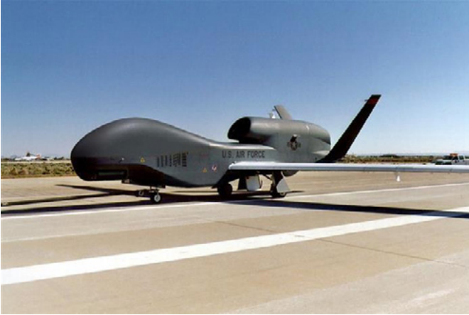
Şekil 2: Northrop Grumman RQ-4 Global Hawk Amerikan yapımı yüksek irtifa insansız gözetleme ve keşif uçağı
