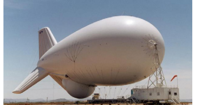
Şekil 7: TCOM 71M balon (alt tarafına AN/TPS-63 adı verilen gözetleme radar sistemi monte edilmiştir)
