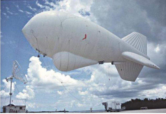
Şekil 8: Lockheed Martin 420K balon (alt tarafına Lockheed Martin L-88 adı verilen gözetleme radar sistemi monte edilmiştir)
