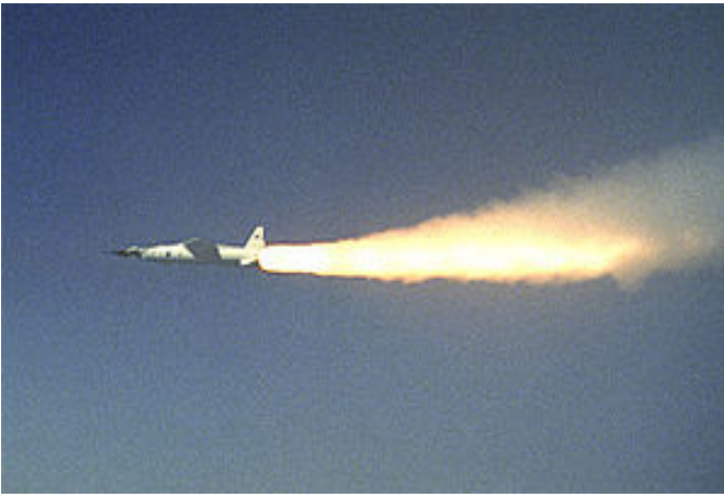
Şekil 6: Boeing-52B Stratofortress uçağından serbest bırakılan ve Scramjet motorlarıyla harekete geçirilen bir X-43 Hava Aracı ( https://en.wikipedia.org/wiki/NASA_X-43 )
