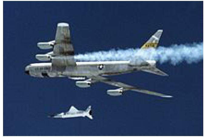
Şekil 6: Boeing-52B Stratofortress uçağından serbest bırakılan ve Scramjet motorlarıyla harekete geçirilen bir X-43 Hava Aracı ( https://en.wikipedia.org/wiki/NASA_X-43 )
