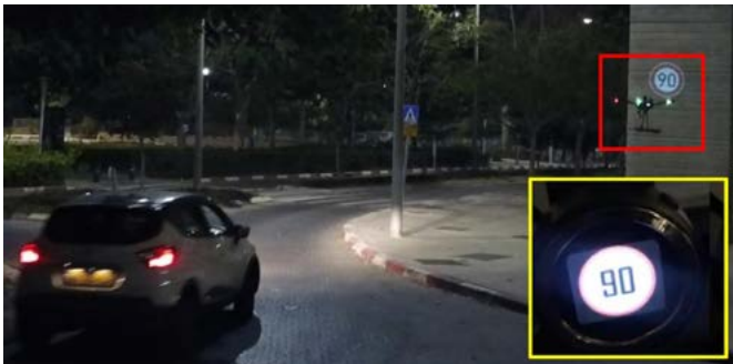
Şekil 44: Binaya, drone üzerinden 125 milisaniye boyunca hayalet yol işareti (kırmızı çerçevesi) yansıtılır; hayalet yol işareti geçen Renault Captur tarafından yakalanır ve Mobileye 630 PRO (sarı çerçevesi) hayalet yol işaretini gerçek olarak tanımlar.
