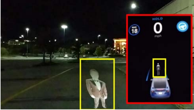
Şekil 46: Tesla'nın otopilotu hayalet görüntüyü gerçek bir insan olarak tanımlar ve harekete başlamaz. Kırmızı çerçeve içinde araçtaki gösterge paneli görülüyor.
