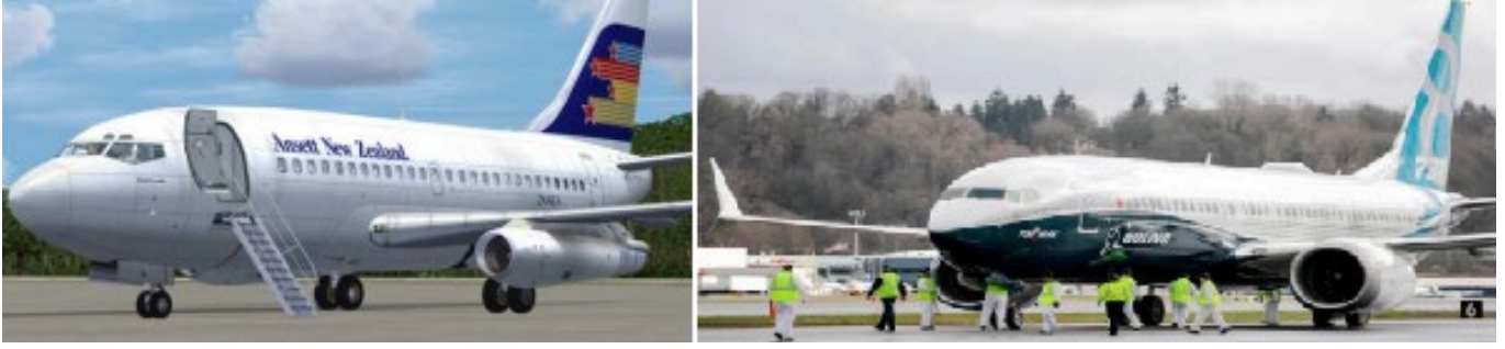
Şekil 71: Orijinal Boeing-737 motoru (solda), büyütülmüş ve yere yakınlaşmış Boeing-737 MAX motoru (sağda).
