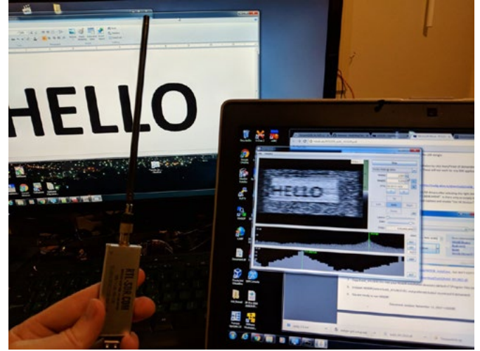
Şekil 49: TempestSDR aracı ile ekranlardan veri sızıntısı
