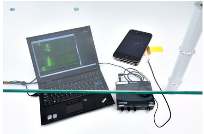
Şekil 47: Cam masa üzerindeki cep telefonunun güç kaynağının hassas problarla dinlenmesi ile anahtarın ele geçirilmesi
