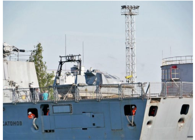
Şekil 4: Rusya'nın Elmas Sistemi'nde kullandığı Inspector Mk 2 suüstü İDA'sı bir fırkateyn üzerinde [42] .
