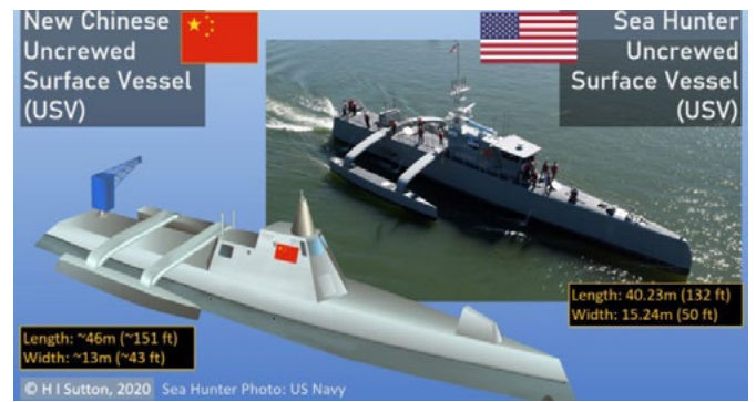
Şekil 8: Çin'in geliştirdiği Trimaran tasarımı İDA ve ABD'nin Deniz Avcısı İDA karşılaştırması [20] .
