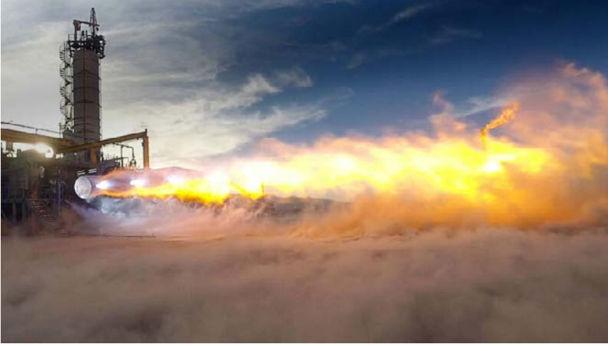
Şekil 3: Blue Origin BD-4 motor testleri 6 .
