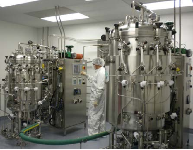
Şekil 2: Yapay et veya gıda üretiminde kullanılacak biyoreaktör modeli [9] .
