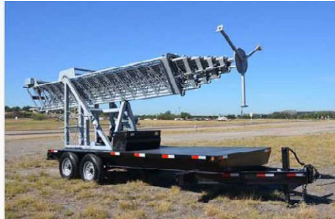
Şekil 11: Portatif telekom kulesi kuruluma hazır hâlde bekliyor [52] .
