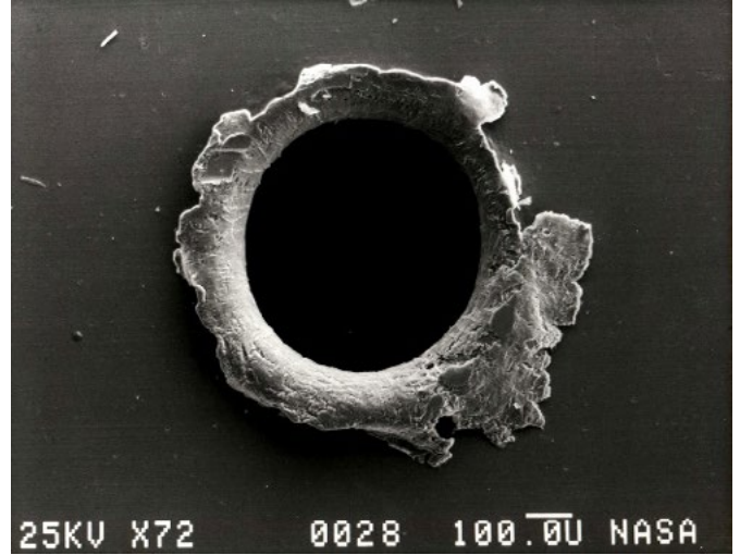
Şekil 3: SMM Uydusu Uzay Çöpü Çarpışma Etkisi [5]
