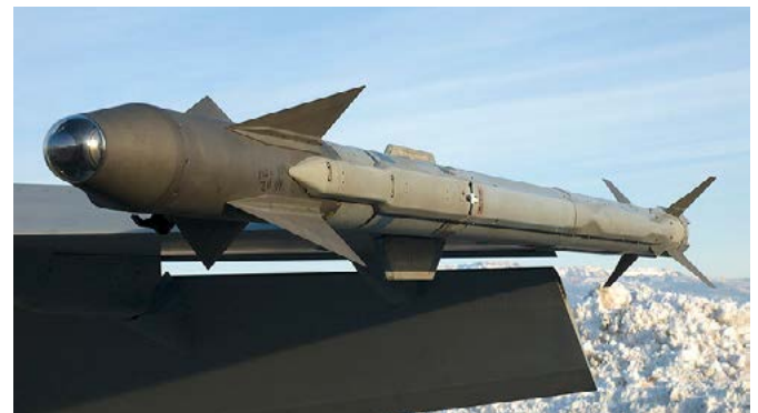
Şekil 19: Bir Savaş Uçağına entegre edilmiş IR güdümlü füze https://manglermuldoon.blogspot.com/2012/05/f-35-development-and-performance.html
