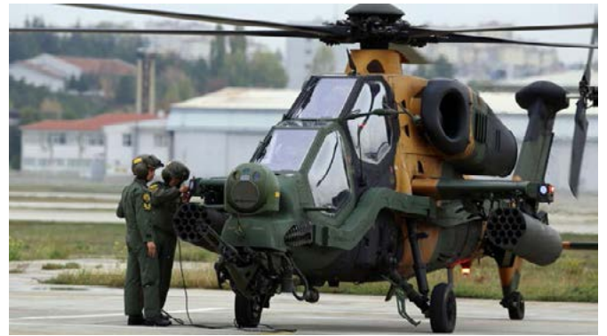
Şekil 12: T129 ATAK helikopterin ön kısmına yerleştirilmiş olan ASELFLIR -300T elektro-optik kamera sistemi http://www.milliyet.com.tr/tarihi-anlasma-turkiye-den-30-ekonomi-2671459/
