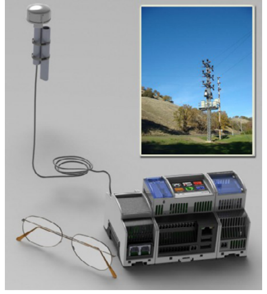
UC Berkeley öncülüğünde yürütülen ve Enerji Bakanlığı ARPA-E programı tarafından finanse edilen bir proje çerçevesinde Power Standards Laboratuvarı'nda geliştirilen mikro fazör ölçüm birimleri, enerji dağıtım şebekelerinin durumsal farkındalığını artırma amacı taşıyor.
